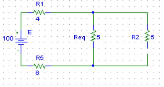
من الشكل نلاحظ ان المقاومتين  $R_2$  و  $R_{eq}$  على التفرع نحسب المقاومة المكافئة لهما .
