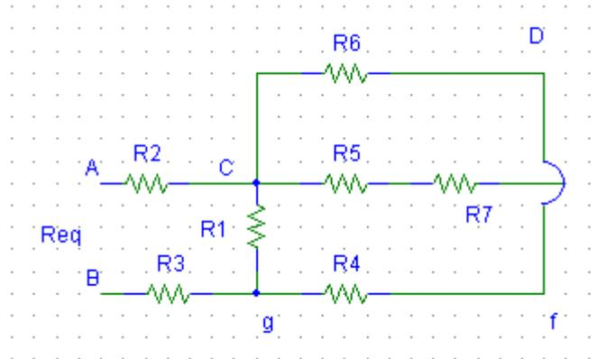
بالاخذ بعين الاعتبار ان  $R_7$  على التسلسل مع  $R_5$  وان هاتين المقاومتين على التفرع مع المقاومة  $R_6$  وبحساب المقاومة المكافئة لهذه المجموعة  $R_8$  نحصل على الشكل
