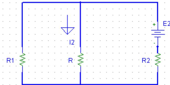
يحسب التيار  $I_2$  المار في المقاومة  $R$  بوجود المنبع  $E_2$  فقط في الدارة بطريقة مقسم التيار حسب العلاقة التالية :
