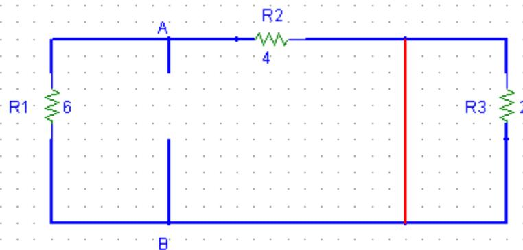
من الشكل نلاحظ ان المقاومة R3 قد قصرت ايضا لا تدخل في حساب المقاومة المكافئة R<sub>TH</sub> ومن الشكل نلاحظ ان المقاومتين R<sub>1</sub> , R<sub>2</sub> موصولتين على التفرع، المحصلة تساوي الى :
