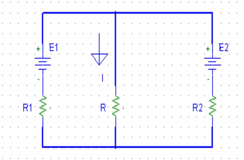
لحساب التيار I المار في المقاومة R بطريقة التثض نتبع ما يلي :
