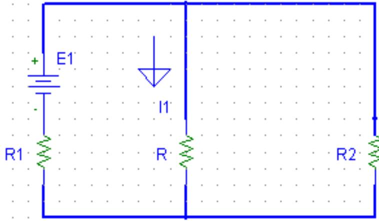
يحسب التيار  $I_1$  المار في المقاومة  $R$  بوجود المنبع  $E_1$  فقط في الدارة بطريقة مقسم التيار حسب العلاقة التالية :
