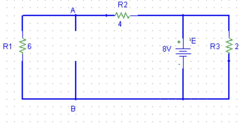
من الشكل نلاحظ ان الجهد بين النقطتين A,B هو هبوط الجهد الحاصل على المقاومة  $R_1$  ، اذا اخذنا الحلقة اليسرى يكون التيار المار في الحلقة مساويا الى :
