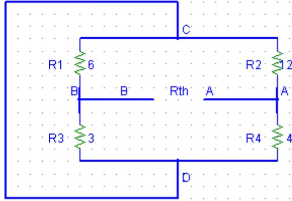
نلاحظ من الشكل ان النقطتين C,D منطبقتين بناء على ذلك تكون المقاومتين  $R_1, R_3$  موصولتين على التفرع وكذلك المقاومتين  $R_2, R_4$  موصولتين على التفرع ومحصلة كل منهما موصولتان على التسلسل ، المقاومة المكافئة تساوي :
