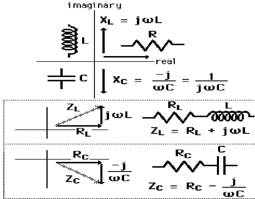
نلاحظ من مثلث التوتر ان هبوط الجهد على المقاومة ينطبق على التيار المار في المقاومة ، وهبوط الجهد على المفاعلة التحريضية يتقدم على التيار بمقدار ٩٠ درجة ، وبالتالي يكون التوتر الكلي يساوي المجموع الشعاعي لهما كما يلي :
