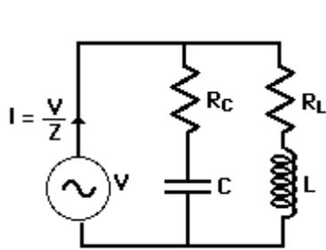
$$\frac{1}{Z_{\text{equiv}}} = \frac{1}{Z_L} + \frac{1}{Z_C} \quad \text{so} \quad Z_{\text{equiv}} = \frac{Z_L Z_C}{Z_L + Z_C}$$
