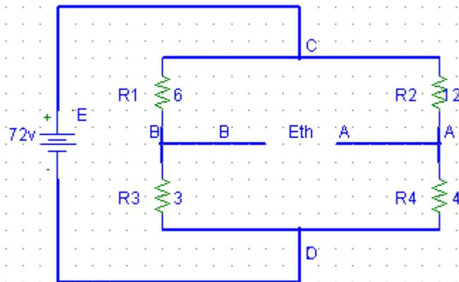
حيث ان الجهد  $E$  المطبق على المقاومتين ( $R_1, R_3$ ) هو نفسه المطبق على المقاومتين ( $R_2, R_4$ ) لذا نستخدم قاعدة مقسم الكمون ( الجهد ) لحساب الجهد المطبق على كل من المقاومتين  $R_1$  .  $R_2$  كما يلي :
