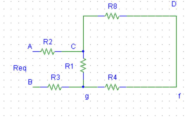
وحسب الشكل الاخير نلاحظ ان المقاومتين  $R_4$  و  $R_8$  على التسلسل وهما على التفرع مع  $R_1$  ومحصلة هذه المجموعة على التسلسل مع المقاومتين  $R_2$  و  $R_3$  وبناء على ذلك نكتب ما يلي :
