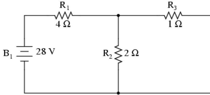
نحسب المقاومة المكافئة للدائرة ومنه نحسب التيار الكلي والتيار المار في المقاومة  $R_2$  كما في الجدول التالي :
